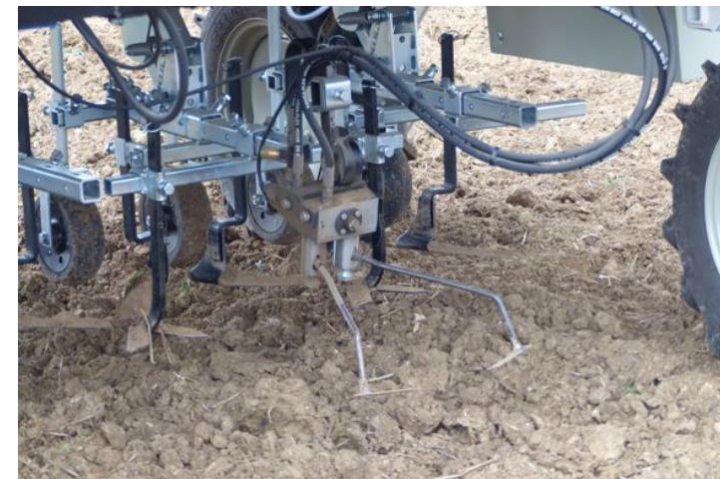
Le binage sur le rang, entre les plants de betteraves sucrières, est assurée par deux petites lames mobiles, animées pour l'heure par un circuit hydraulique.
