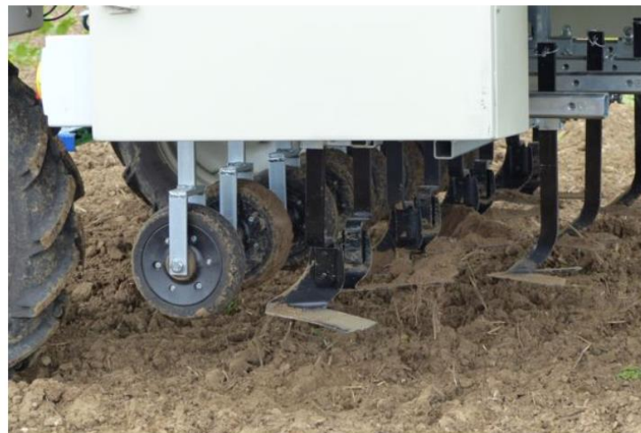
Des socs pattes d'oie assurent, pour leur part, le désherbage mécanique entre les rangs de betteraves sucrières.
