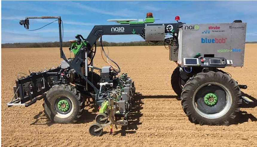
©Strube D&S: Désherbage à 6 rangs avec un robot à navigation autonome
